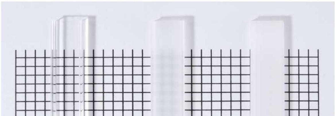
Darstellung verschiedener LED-Stripes mit unterschiedlichem Pixel-Pitch in Kombination mit dreierlei Lichtdurchlässigkeiten in den Abdeckungen. Diese kleine Auswahl veranschaulicht deutlich die optischen Unterschiede einiger LED-Stripes in Kombination unterschiedlicher Abdeckungen.
