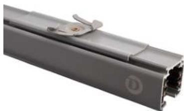
Mit diesem kleinen »Tausendsassa« wird die Montage einer Stromschiene an einer vorhandenen Rasterdecke zum Kinderspiel. Die Montagezeit beträgt nur noch einen Bruchteil der bisherigen. Die Klammer wird im ersten Schritt ganz einfach in die sichtbaren Metallstreifen der Rasterdecke eingeklickt und hält mittels Sicherungs-Federbügel absolut fest an der Decke. Danach wird einfach nur noch die Stromschiene aufgeschoben und fertig ist die Montage.
